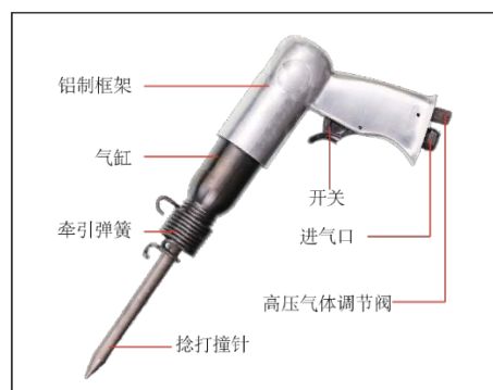
图 3-5 捻打气锤示意图
