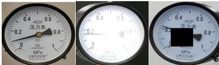
图 5-6 原图、加光照、加遮挡的指针式仪表图片
