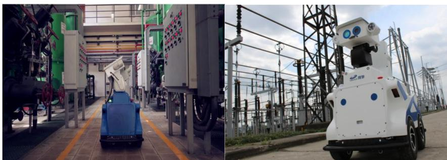
图 1-1 电厂巡检机器人
