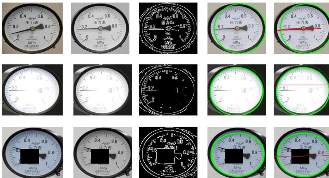
图 5-7 使用传统图像处理方对三种不同情况下的指针式仪表进行示数识别
