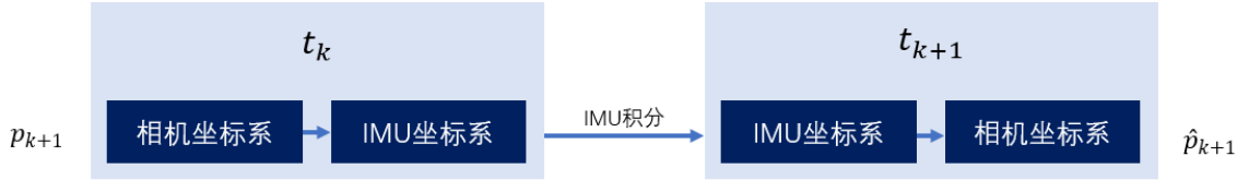
图 2-7 预测 t_{k+1} 时刻特征点的图像坐标过程
