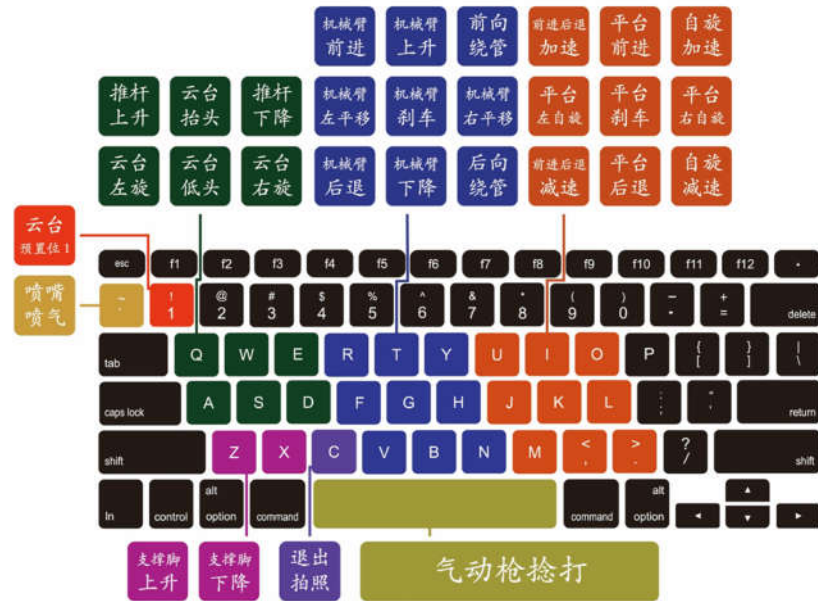
图4-2 带压堵漏机器人键盘控制设计分布图
