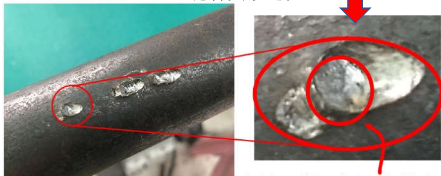
成功堵漏，捻打形成圆形凹痕堵住砂眼
