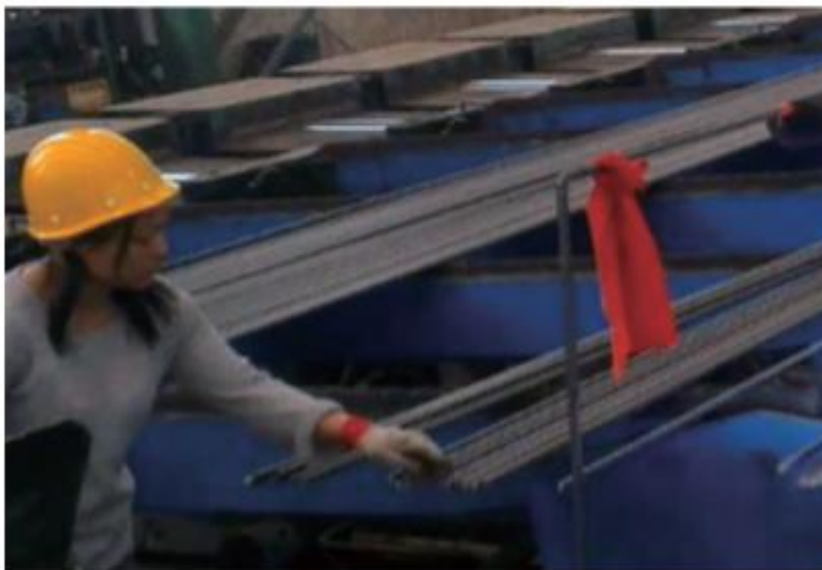
图 1-2 人工对钢筋进行分离和计数
