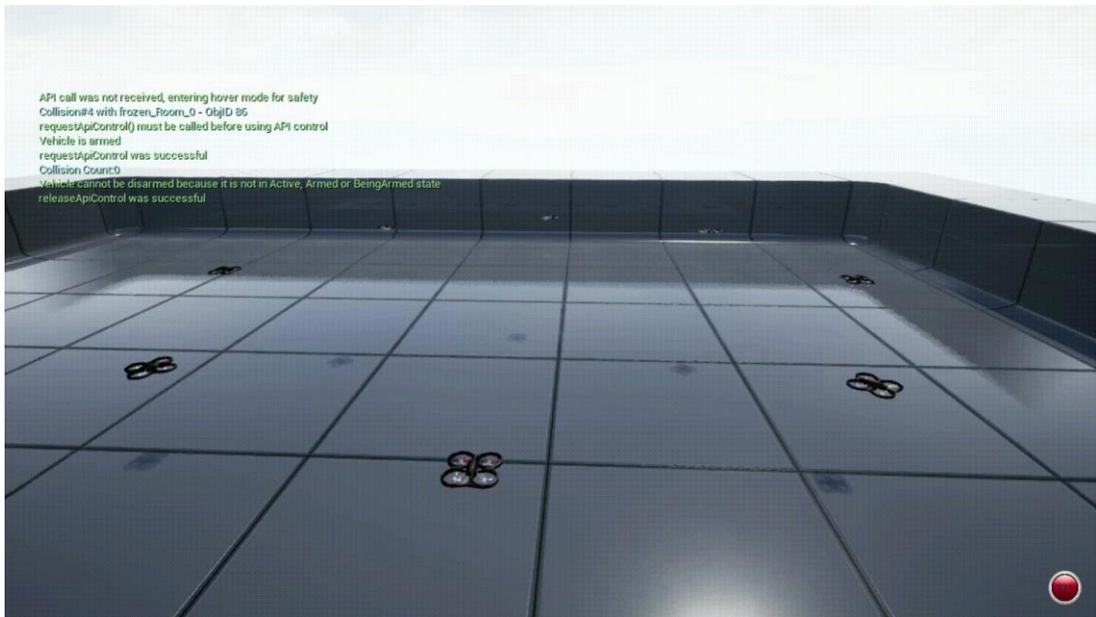
图4-5 通过RL+CNN方法训练的避障导航策略在圆形场景中无人机会在中间点相撞
