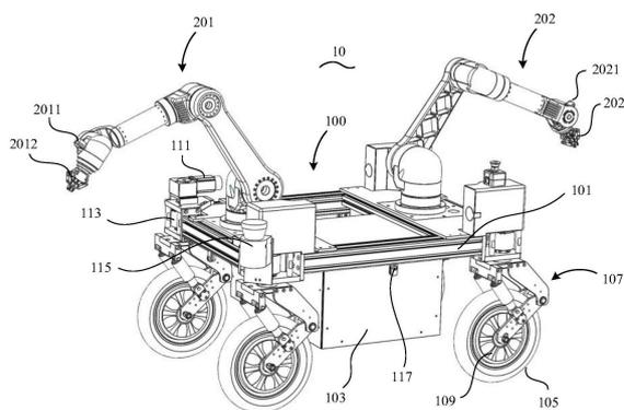
1. 一种复合型移动机器人,其特征在于,包括一移动平台和安装于所述移动平台上的机械臂、工控机、传感器系统和供电模块,所述移动平台安装有能使所述移动平台全向运动的行走装置;所述工控机设置于所述移动平台上,且与所述机械臂和所述移动平台电连接,用于控制所述移动平台的所述行走装置和所述机械臂的运动;所述传感器系统设于所述移动平台和所述机械臂上,并与所述工控机连接,所述供电模块与所述工控机连接,并为所述工控机、移动平台、机械臂和传感器系统进行供电。
