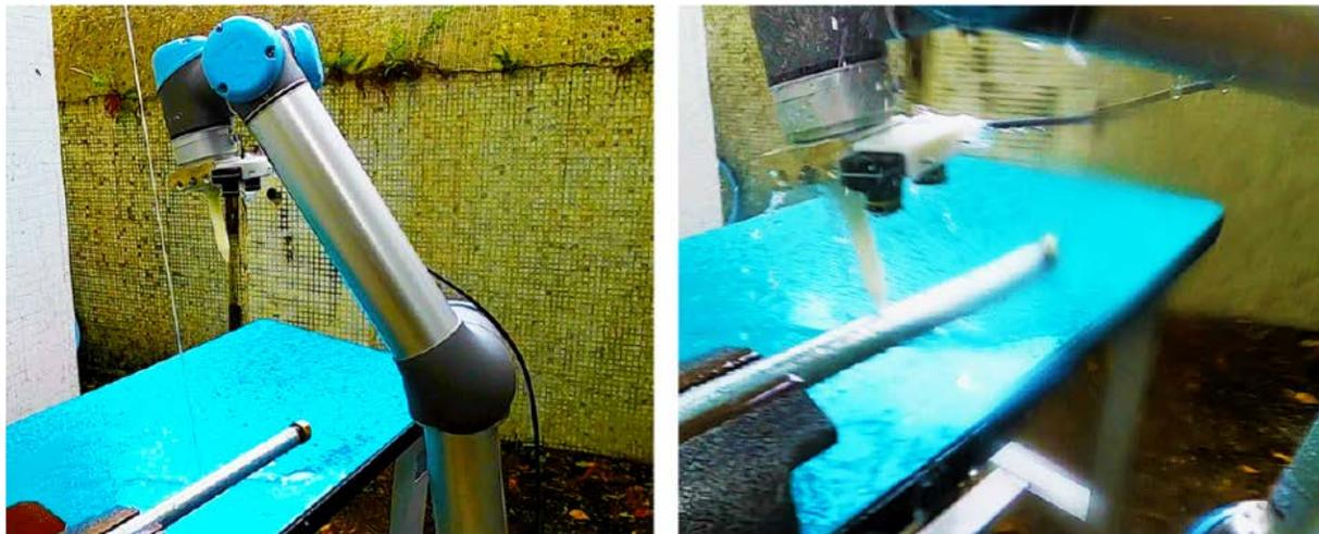
管道漏点定位实验
