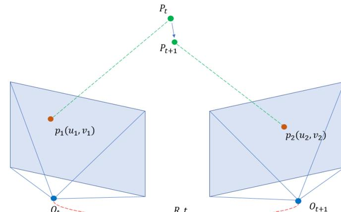
Fig.2 动态物体破坏对极几何
