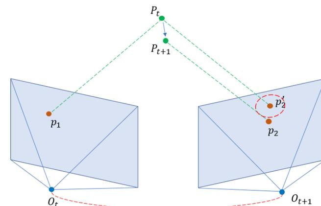
Fig.3 噪声点检测
