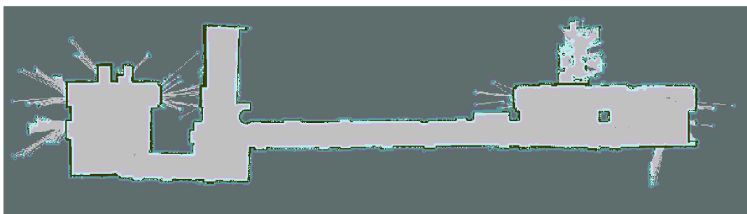
图 5-12 利用 Gmapping 所构建的实验场景的二维地图
