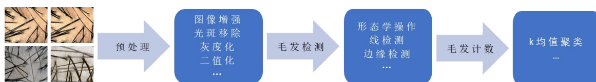
图 1-1 经典数字图像处理技术对毛发镜图像中毛发进行计数的一般流程
