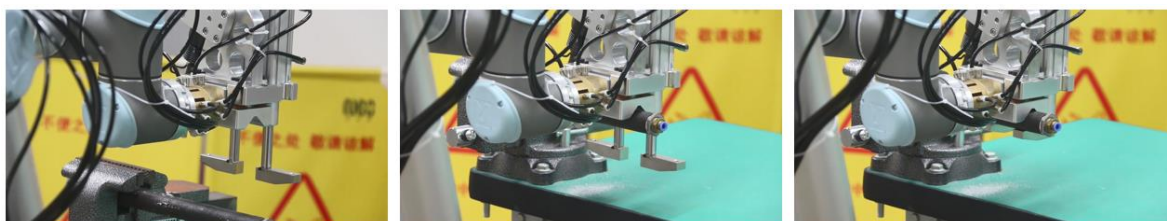
(b) 带压堵漏机器人装配捡打末端进行管道夹取功能测试
