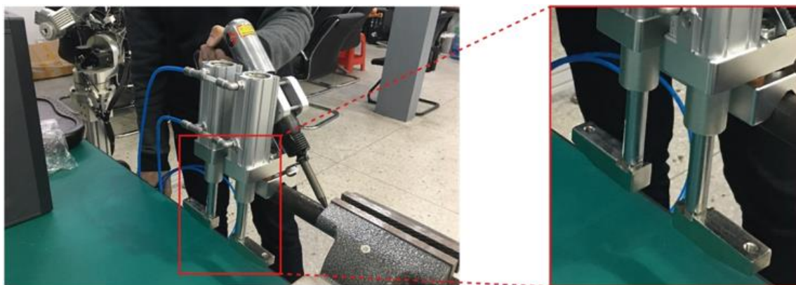
图 3-5 夹爪打开的实际情况
