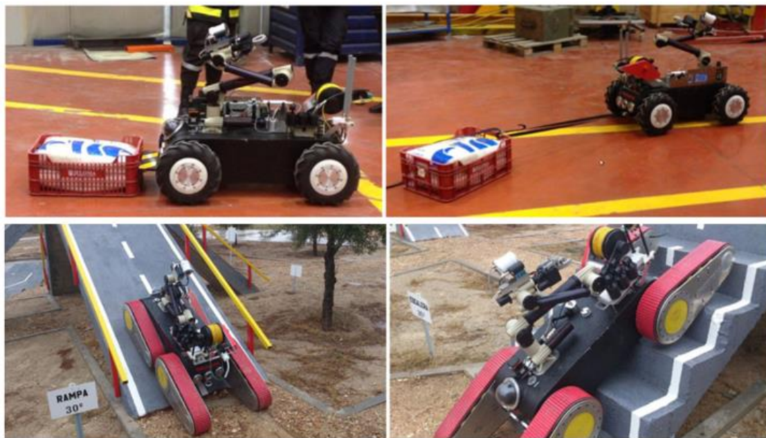
图 1-14 针对不同的任务实现的模块化特种机器人配置 [58]
