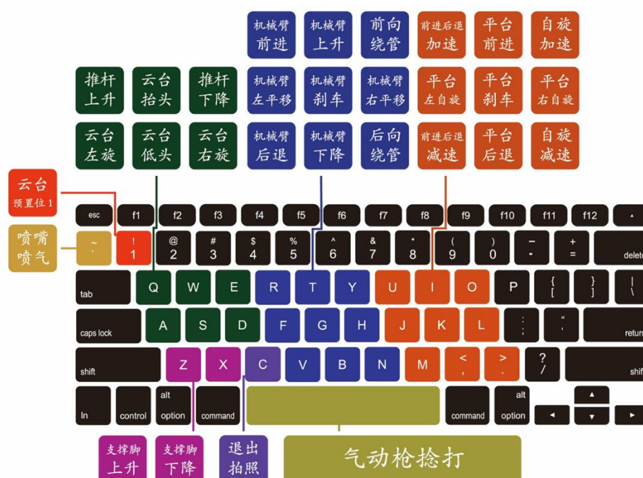
图 4-6 带压堵漏机器人键盘控制设计分布图
