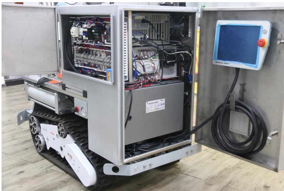
图 3-18 电气柜与控制柜实物图
