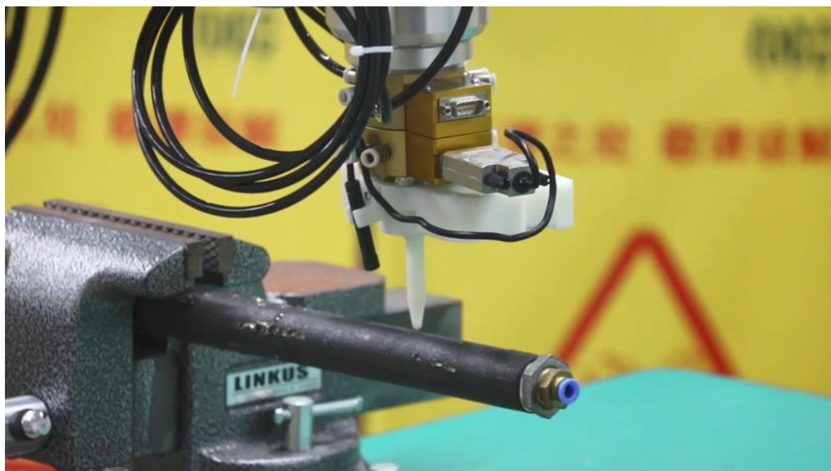
(b) 带压堵漏机器人装配探针末端进行近距离观察功能测试
